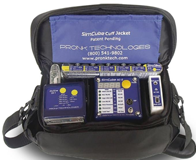
**Conjunto de simuladores multiparamétricos: OX-1, SIMCUBE SC-5 y SIMSLIM SL-8;** portátiles, resistentes y de fácil operación, para la calibración o verificación de monitores de signos vitales.
