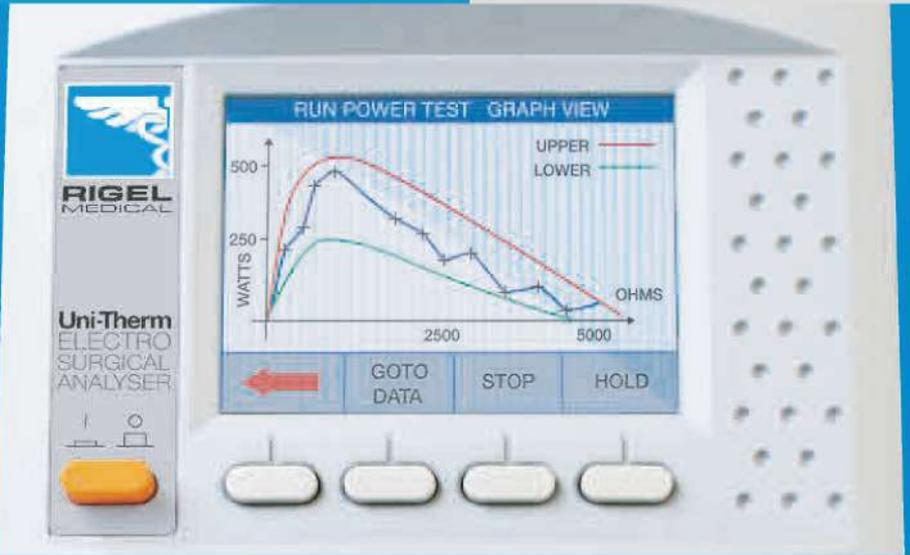
Mostrando las curvas de energía del fabricante y las tolerancias permisibles en su gran pantalla a color proporciona una indicación de desempeño instantáneo
