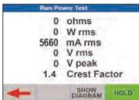
El nuevo diseño del banco de carga es capaz de medir la corriente hasta 6<sup>o</sup> ARMS con un ciclo de trabajo máximo del 100% hasta por 60 segundos. Esto asegura que el Uni-Therm de Rigel sea compatible con todos los equipos de electrocirugía de alta potencia disponibles en el mercado.
