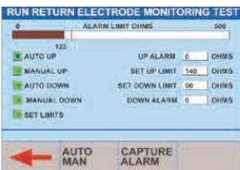
Utiliza el selector rotatorio para ajustar los niveles altos y bajos de la alarma, y controlar el potenciómetro, además puede ajustar los valores hacia arriba o hacia abajo en modo manual o automático.
