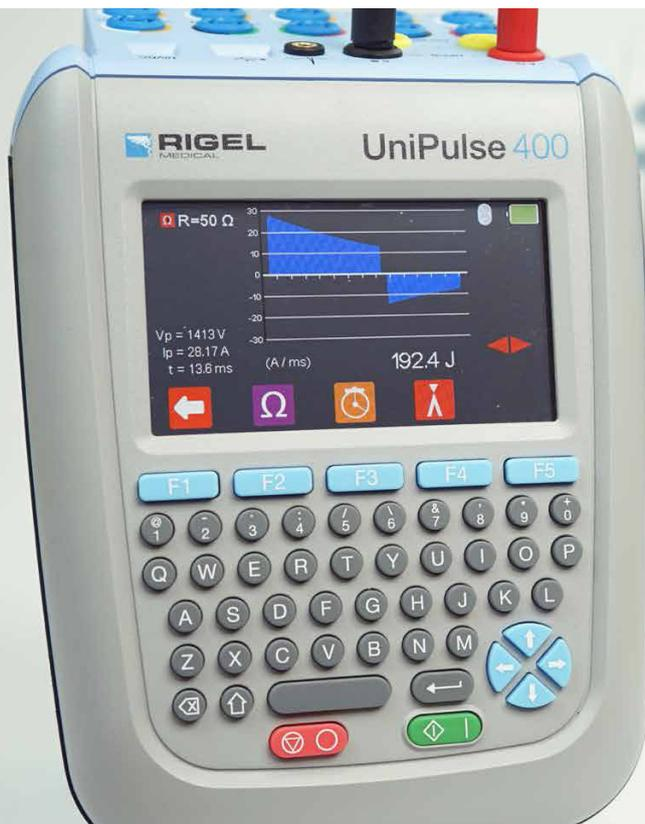
El nuevo UniPulse 400 está diseñado para probar exhaustivamente todos los desfibriladores con exactitud y eficiencia. La pantalla a color mostrará resultados de prueba y formas de onda en detalle asombroso. Las teclas rápidas dedicadas y el sistema operativo fácil de usar permite a los ingenieros de prueba seleccionar funciones de prueba relevantes en segundos.
