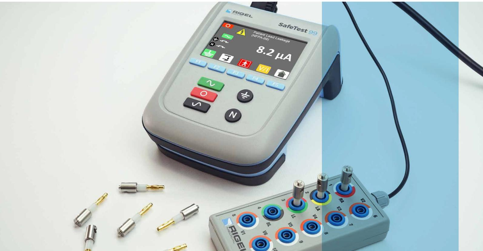
El nuevo SafeTest 99 es un analizador de seguridad eléctrica general grado médico, simple, robusto y rentable que efectúa pruebas a partes aplicadas. Con una amplia pantalla a color y una interfaz de usuario codificada por colores, es fácil seleccionar la interfaz de prueba requerida con tocar un botón.
