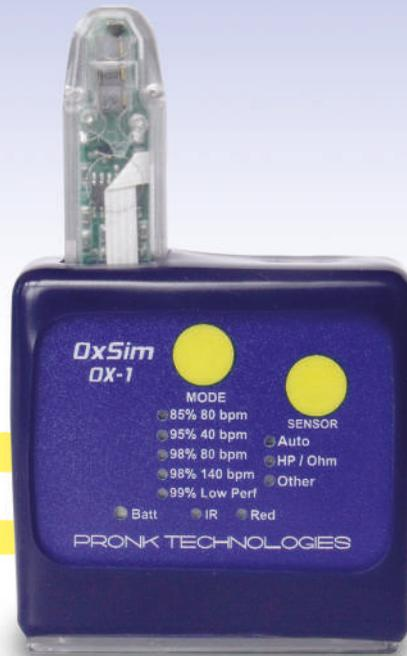
Dispositivo electrónico que emula la saturación sanguínea de oxígeno mediante una señal de luz óptica.
