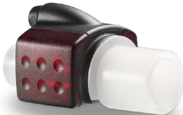
El sensor OR-703 es práctico para utilizarse por su diseño compacto. Gracias al avance del estado del arte de la tecnología de microsistemas, el sensor OR-703 ofrece flexibilidad única para probar la dosificación y el monitoreo de gases anestésicos, así como la medición precisa de CO<sub>2</sub>. El sensor mide la absorción de luz infrarroja a varias longitudes de onda para determinar exactamente la concentración de las mezclas de gases.
