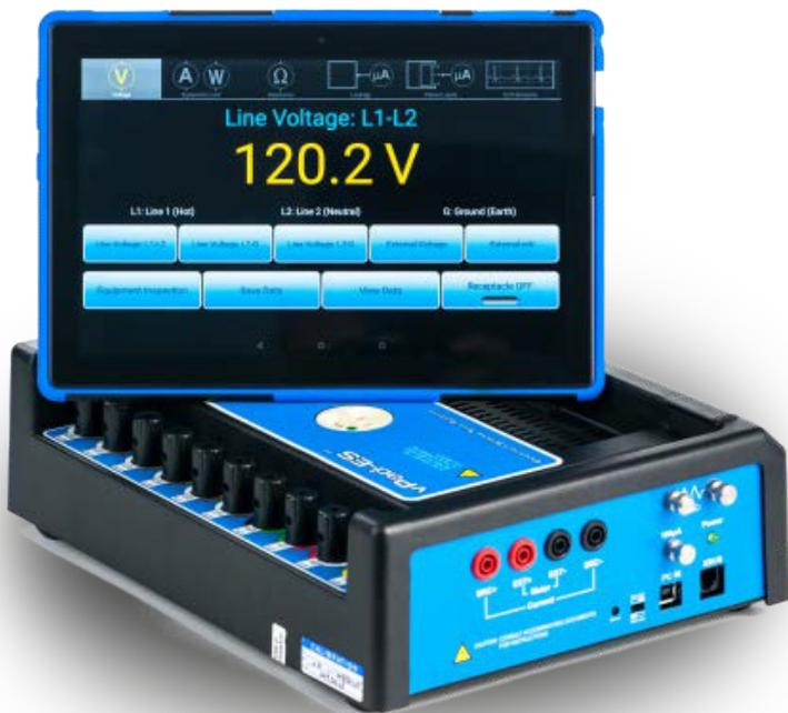
**Analizador de seguridad eléctrica** para equipo electromédico, con tablet como interfaz de usuario para un manejo fácil, claro e intuitivo durante la ejecución de **pruebas en condiciones normales o de falla única** bajo diferentes estándares.
