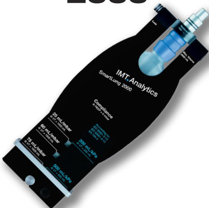
**Simulador de pulmón** con valores fijos de complianza y resistencia para la rápida verificación del funcionamiento de **ventiladores mecánicos y máquinas de anestesia**.
