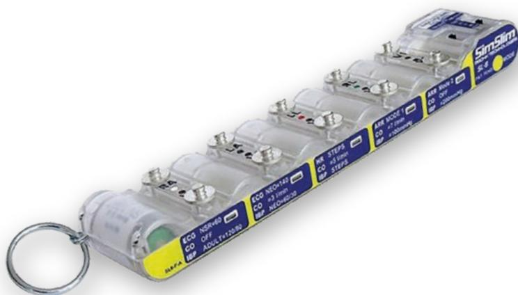
**Simulador de saturación de oxígeno** portátil y resistente con una operación sencilla utilizando solo 2 botones, para la **calibración o verificación** de monitores de signos vitales que cuentan con medición oximetría de pulso.
