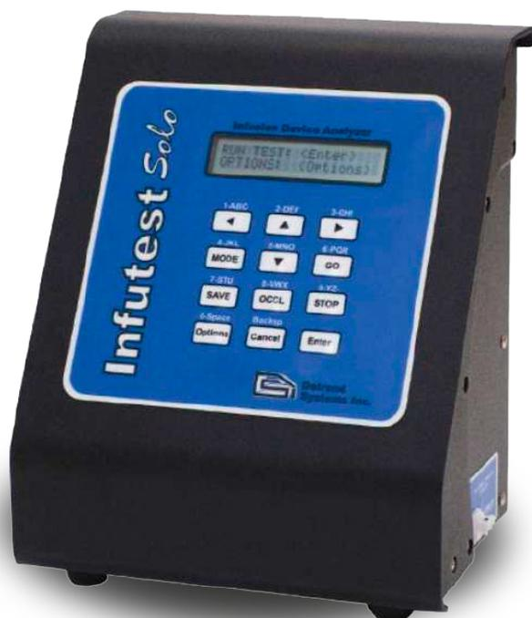
**Analizador de bombas de infusión** con batería de alto rendimiento y almacenamiento interno de resultados para **pruebas y calibración** de bombas de infusión de jeringa, peristálticas, de cassette o de cualquier tipo.
