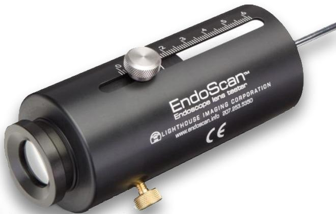
Dispositivo **analizador** de daños en lentes de **endoscopios rígidos**.
