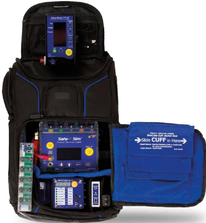
**Kit de simuladores y analizadores** para la verificación integral a monitores de signos vitales y bombas de infusión, incluyendo pruebas de desempeño y seguridad eléctrica, conformado por **Flow-Trax-2, SimCube SC-5, SimSlim SL-8, Oxsim Flex Ox2 y Safe T-sim**, los más portátiles, resistentes y de fácil operación.
