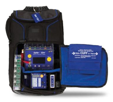
Kit de simuladores y analizadores para la verificación integral a monitores de signos vitales, incluyendo pruebas de desempeño y seguridad eléctrica, conformado por SimCube SC-5, SimSlim SL-8, Oxsim flex Ox2 y SafeT-sim, los más portátiles, resistentes y de fácil operación.
