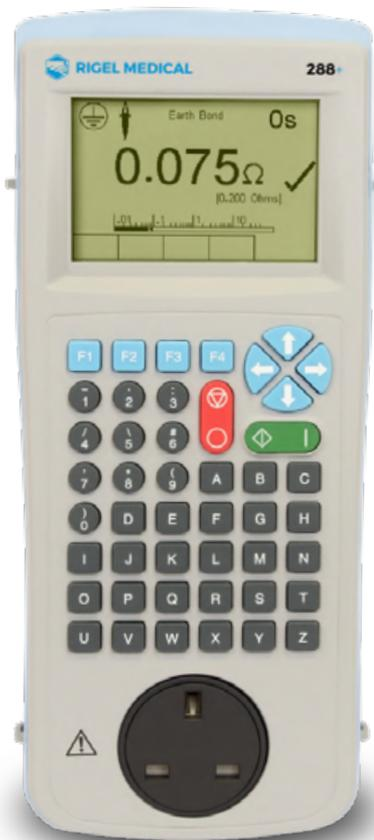
**Analizador de seguridad eléctrica para equipos electromédicos**, con ejecución de pruebas en condiciones normales y condiciones de falla única, en modalidad manual y automática, siguiendo los estándares **IEC-62353**, **IEC-60601-1** y **NFPA 99**.
